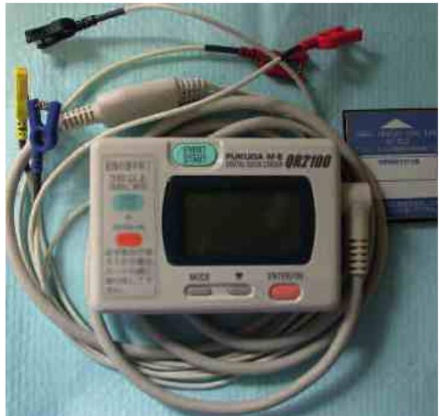
**Figure 1 :** Le boîtier d'enregistrement numérique a remplacé le boîtier analogique. La carte « Flash », à droite de l'enregistreur, peut être lue par un ordinateur conventionnel qui dispose d'un logiciel spécifique. Le petit écran à affichage sur le boîtier permet de visualiser le tracé et de vérifier sa qualité avant de lancer l'enregistrement.
