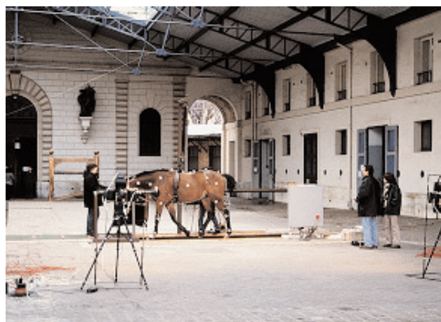
Figure 2 : Vue générale de l'aire d'enregistrement. Le cheval est équipé de marqueurs réfléchissants placés en regard des articulations et sur la ligne du dos. Deux caméras entourées de projecteurs sont disposées à 4 m du tapis roulant, leurs axes de convergence faisant un angle de 60°.
