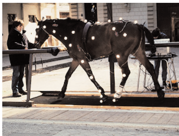
Figure 1 : Cheval équipé de capteurs EMG et de marqueurs cinématiques au trot sur tapis roulant.
